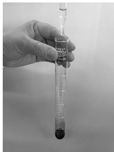
写真4 チオ硫酸ナトリウム水溶液をうがい薬に滴下する操作
