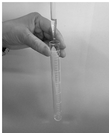
写真3 スポイト瓶から目盛り付き試験管への滴下
