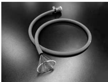
写真10 漏斗を付けたゴム管
