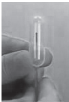
写真13 ディスポピペットに白金黒を挿入
