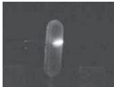
写真11 白金線による水素の燃焼(暗所)
