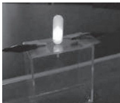
写真5 水素の燃焼時の発光（暗所）
