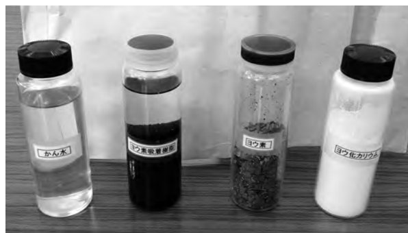
写真3 かん水、ヨウ素吸着樹脂、ヨウ素、ヨウ化カリウム (提供：日本天然ガス株式会社)
